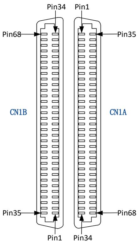
图 3-3-2 CN1 VHDCI 连接器管脚定义
