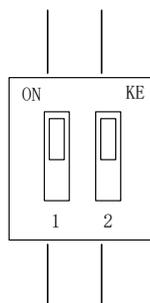
S1-S16: 用于为每个端口选择终端电阻, S1 对应串口 1, S2 对应串口 2, 以此类推。
