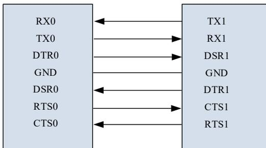
图 4-1-2 全功能串口信号连接
